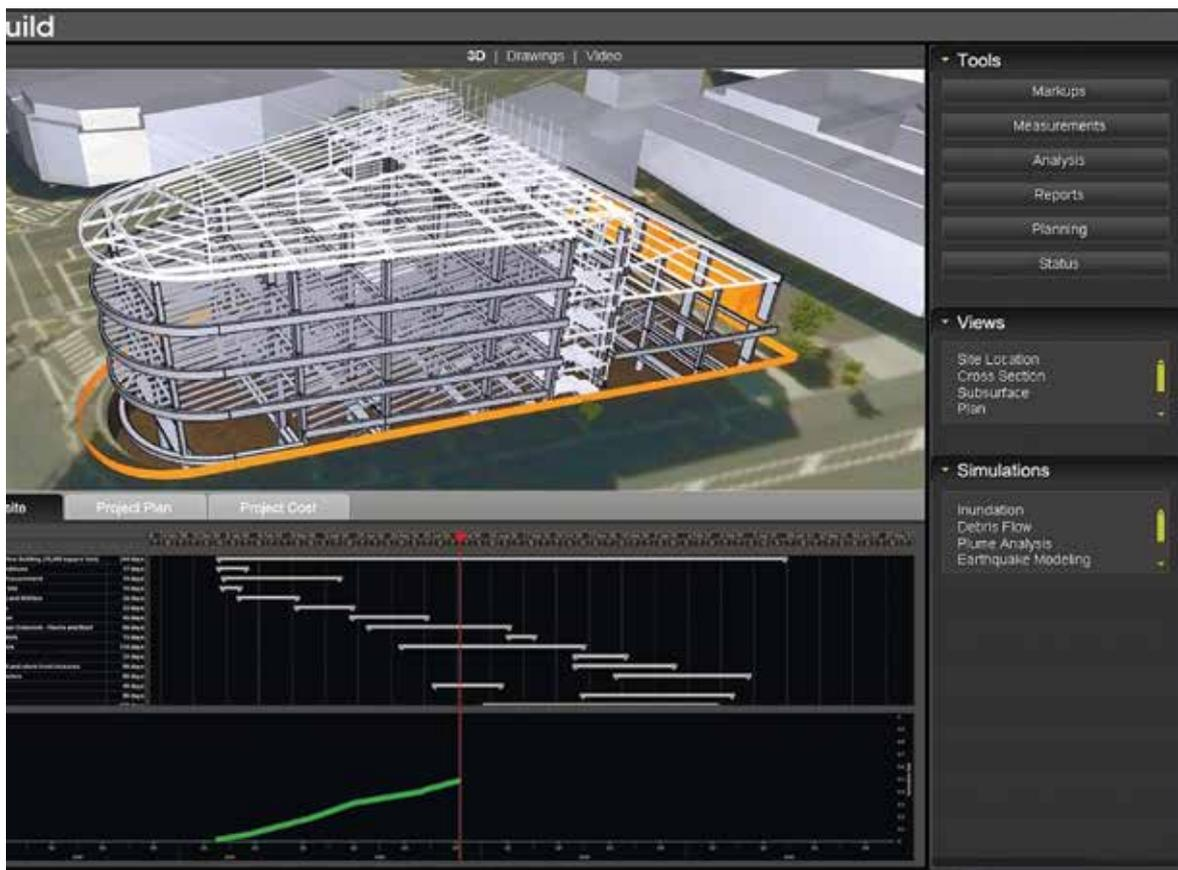
Рисунок 36. Интерфейс BIM системы GeoBuild для застройщика
